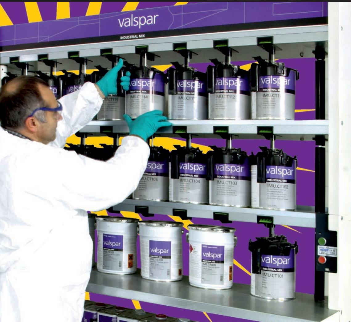
Чтобы сократить время на поиски нужного цветового оттенка и достичь максимального цветового соответствия концерн Valspar разработал компьютерный подбор промышленных эмалей, который путем смешивания базовых цветов в определенных весовых пропорциях позволяет получать нужные цветовые оттенки.
